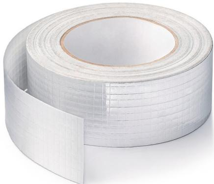
Лента Alutape ARM – алюминиевая лента, армированная стеклосеткой с размерностью ячейки 5x5 мм, на одну сторону которой нанесен клеевой слой, закрытый антиадгезионным лайнером. Лента предназначена для фиксации теплоизоляционных изделий Aeroflex с покрытиями Alu в проектном положении, а также для герметизации kleевых соединений между теплоизоляционными изделиями с целью защиты от проникновения грязи, пара и воды.
