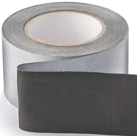
Лента FG-tape – лента из технической стеклоткани черного цвета, на одну из сторон которой нанесен клеевой слой, закрытый антиадгезионным лайнером. Лента предназначена для фиксации теплоизоляционных изделий Aeroflex с покрытием FG в проектном положении, а также для герметизации kleевых соединений между теплоизоляционными сегментами, их защиты от проникновения грязи, пара и воды.
