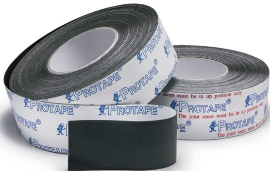
Лента Protape – гибкая монтажная лента из невспененного EPDM каучука, на одну сторону которой нанесен самоклеящийся слой. Лента Protape обеспечивает экстра-защиту kleевых соединений между смежными изделиями Aeroflex и надежно фиксирует теплоизоляцию в проектном положении. Не является ПВХ-лентой и не имеет аналогов на Российском рынке.
