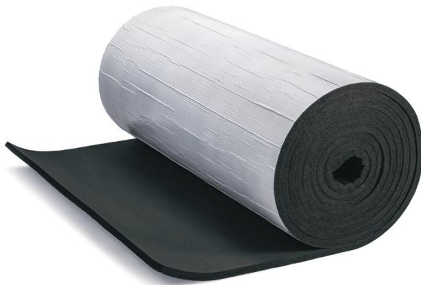
Клеевой слой S представляет собой состав постоянной липкости на полиэфирной сетке, защищенный лайнером на основе силиконизированной полипропиленовой пленки. Используется при изготовлении рулонов и листов марок EPDM, FIRO в исполнении S и производстве лент. Теплоизоляционные материалы Aeroflex в исполнении S приклеиваются к изолируемой поверхности без использования дополнительных крепежных элементов, что упрощает монтаж и увеличивает скорость его выполнения.
