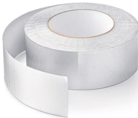
Лента Alutape изготовлена из алюминиевой фольги с kleевым слоем, закрытым антиадгезионным лайнером. Применяется для герметизации швов и фиксации теплоизоляционных изделий Aeroflex с алюминизированными покрытиями Alu, Metal Pro и FG Alu в проектном положении.
